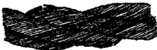
Рисунок 1. Обрывы и смещения проволок каната крестовой свивки.
