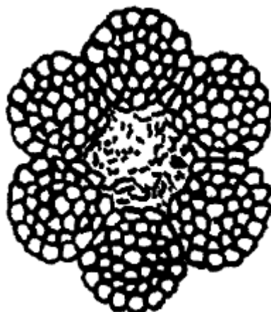
Рисунок 7. Уменьшение площади поперечного сечения проволок (интенсивная внутренняя коррозия).
